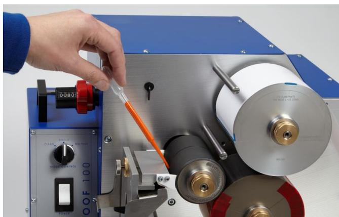
3 Appliquer l'encre à l'aide d'une pipette jetable. Les barres latéraux installés à chaque extrémité de la racle constituent un réservoir contenant suffisamment d'encre pour produire plusieurs épreuves si nécessaire.
