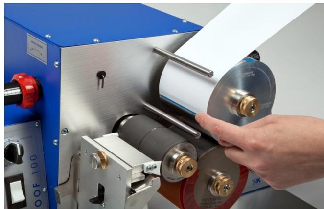
2 Installez le substrat (105 mm x 297 mm) sur le rouleau d'impression; il est maintenu par une bande adhésive. Vitesse d'impression réglable jusqu'à 99m/min.
