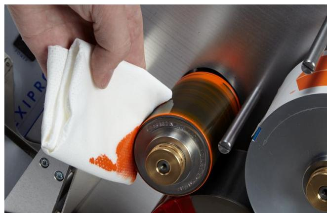
6 Nettoyez le rouleau anilox pendant qu'il tourne. La plaque d'impression est également facile à nettoyer avec la machine à l'arrêt. Utilisez le miroir pour vérifier qu'il est propre.
