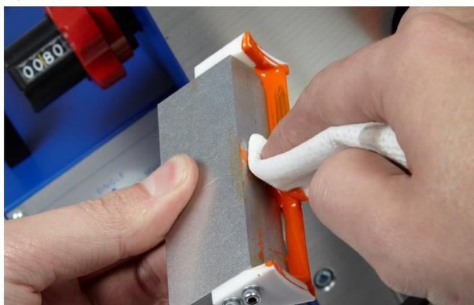
5 Nettoyez la lame, le porte-lame et les barres latéraux avec un solvant approprié.
